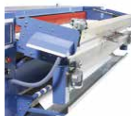
Introdutora ergonómica de 500 mm com altura ajustável.
